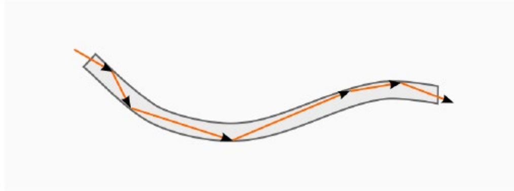
Totalreflexion in einem Lichtleiter.
